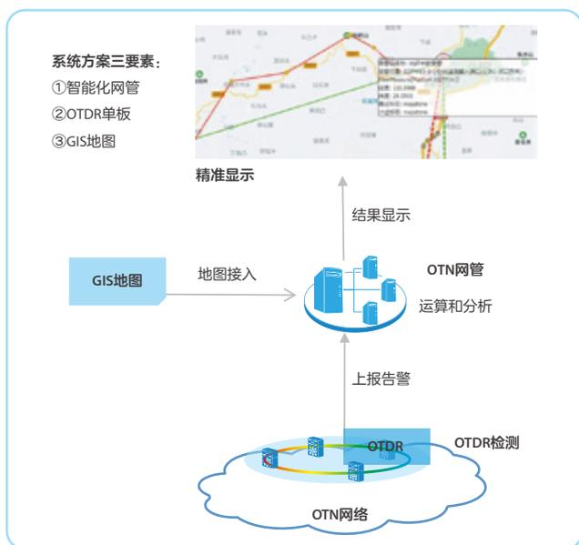
▲图1 光纤故障智能化定位系统方案架构
