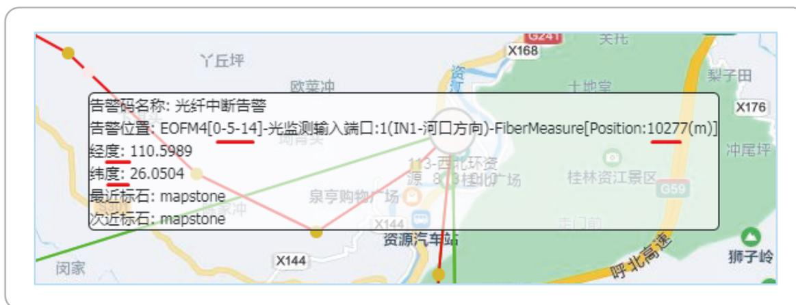
图2 GIS地图中显示的故障点信息
